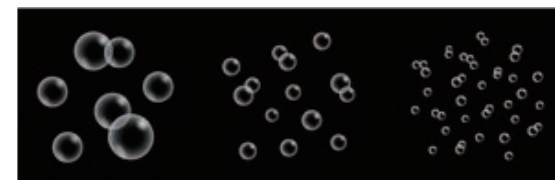
ミリバブル 100μm以上 マイクロバブル 1μm～100μm未満 ウルトラファインバブル 1μm未満
